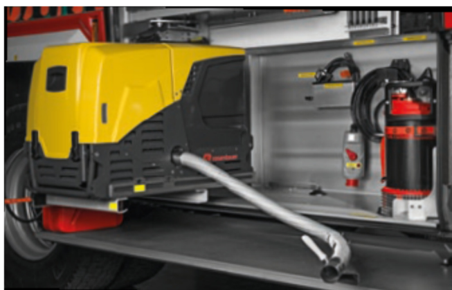
Manguera de escape de gas
